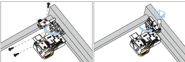
Отодвиньте в сторону подвижную часть и прикрепите шурупами замок к фасаду и, при возможности, к дну ящика. Верните на прежнее место подвижную часть и зафиксируйте ее винтом.
