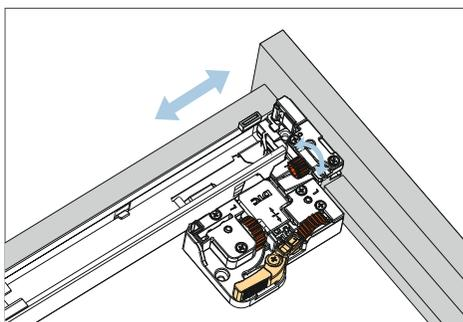
Регулировка по глубине
